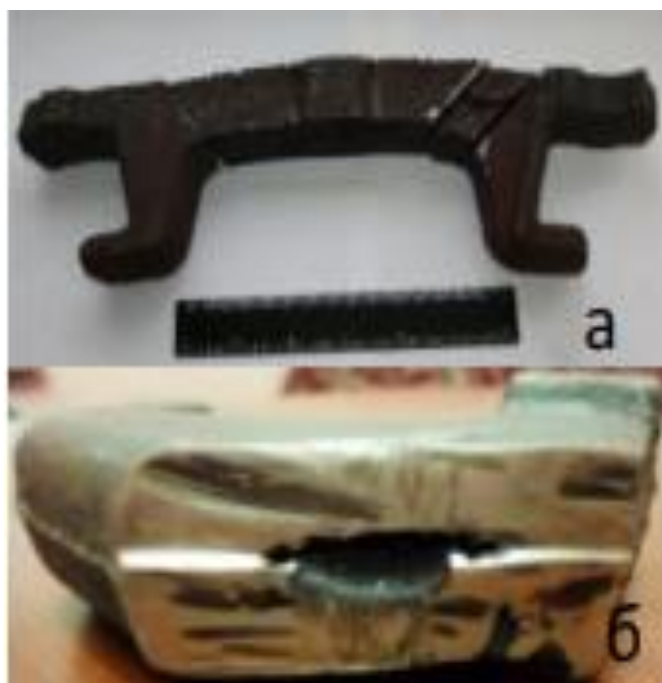
Рисунок 4.4 – Короблення: а – розрізаний для пошуку усадкових раковин; б – усадкова раковина в замковій частині
