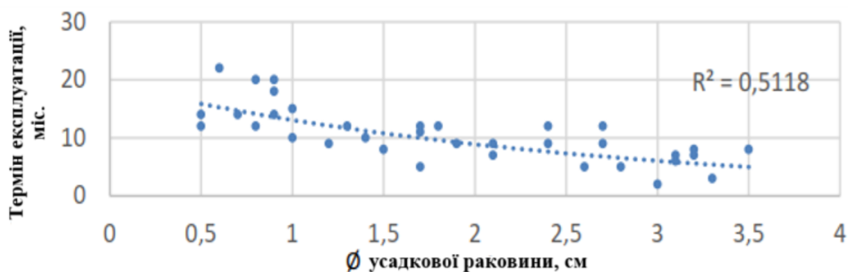
Рисунок 4.5 – Залежність терміну експлуатації від розміру усадкової раковини з експоненційною лінією тренду
