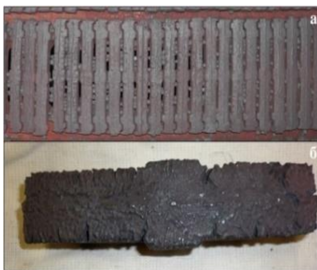
Рисунок 4.6 – Колосники після 6 місяців експлуатації: а – встановлені на випалювальному візку; б – середня частина демонтованого з балок колосника (вид зверху)
