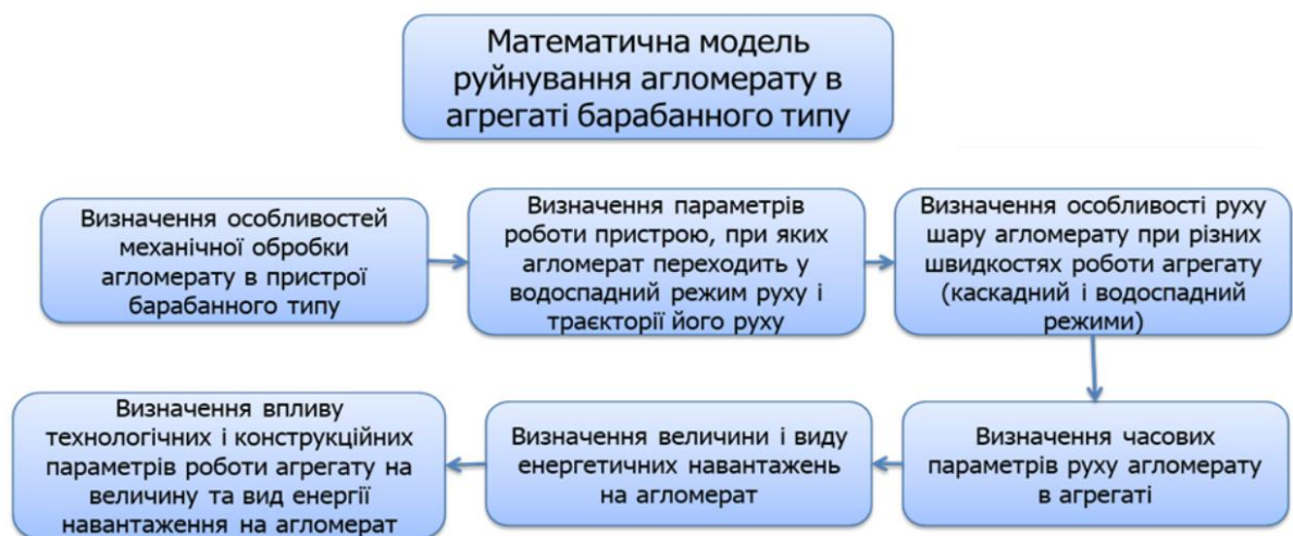
Рис. 1.9. Структура моделі руйнування агломерату в агрегаті барабанного типу
