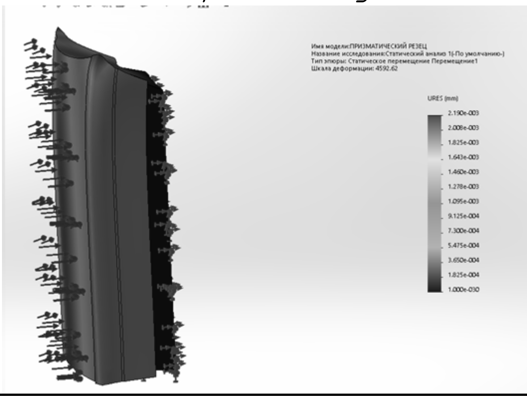
Дослідження "Переміщення" у SW Simulation
