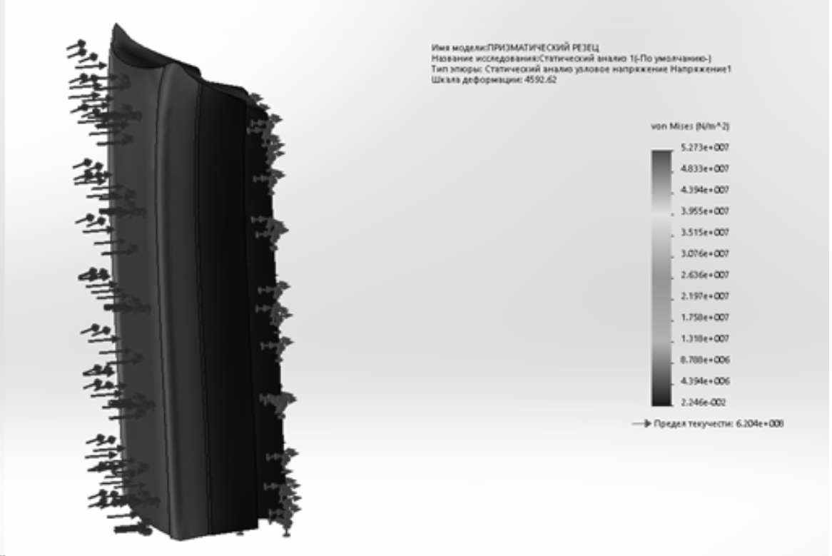
Дослідження "Напруження" у SW Simulation
