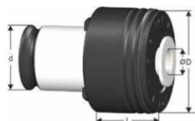
Рисунок 3.26 – Цанга для нарізування різьби [14, G-24] Геометричні параметри: \varnothing=8 ; D=32 ; d=19 ; L=25
