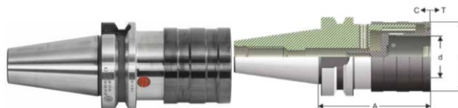
Рисунок 3.25 - Різьбонарізний патрон JIS B 6339 [15, С-23] Геометричні параметри: d=19 ; A=67 ; D=38 ; C=7 ; T=7 ; Діапазон M2-M14; Конус – BT40
