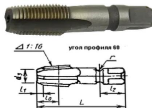
Рисунок 3.16 – Мітчик конічний дюймовий K1/8 P6M5 Геометричні параметри: D=1,8 L=55; l=18; l0=11; l1=2,8; l2=16; D=10,7; dcp=9,519; d1=8; d2=7; d3=8;
