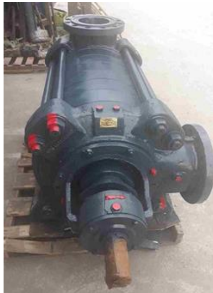
Рисунок 1.3 – Зовнішній вигляд насосу ЦНС 300-600
