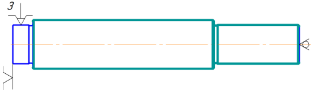
Рисунок 2.3 – Схема базування при обробці вала на операції 030 (токарна)
