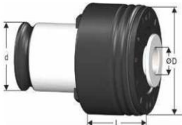
Рисунок 3.17 – Цанга для нарізування різьби M12 [6, G-24] Геометричні параметри: \varnothing=9 ; D=50 ; d=31 ; L=31
