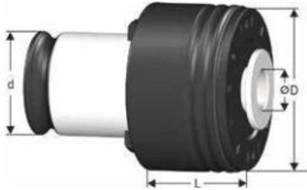
Рисунок 3.18 - Цанга для нарізування різьби М10 [6, G-24] Геометричні параметри: \varnothing=7 ; D=50 ; d=31 ; L=31
