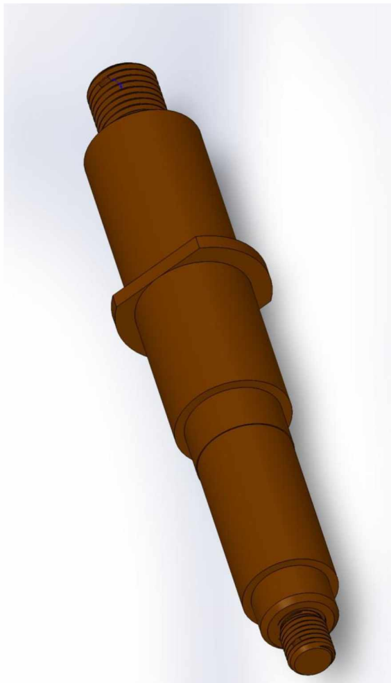
Рисунок 1.1 – Тривимірна модель деталі «Вісь» та загальний вигляд
