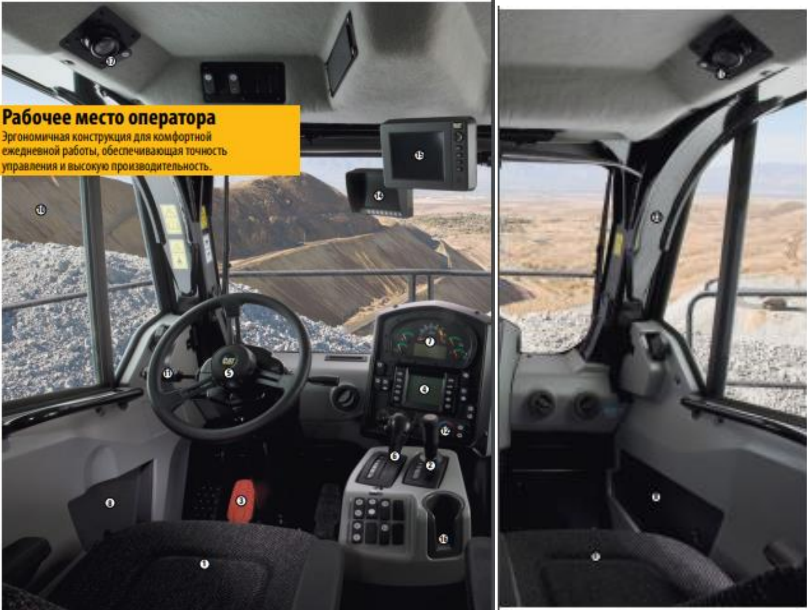
Рисунок 3.7 – Кабіна керування самоскиду Caterpillar 797F з робочим місцем оператора та місцем для інструктора
