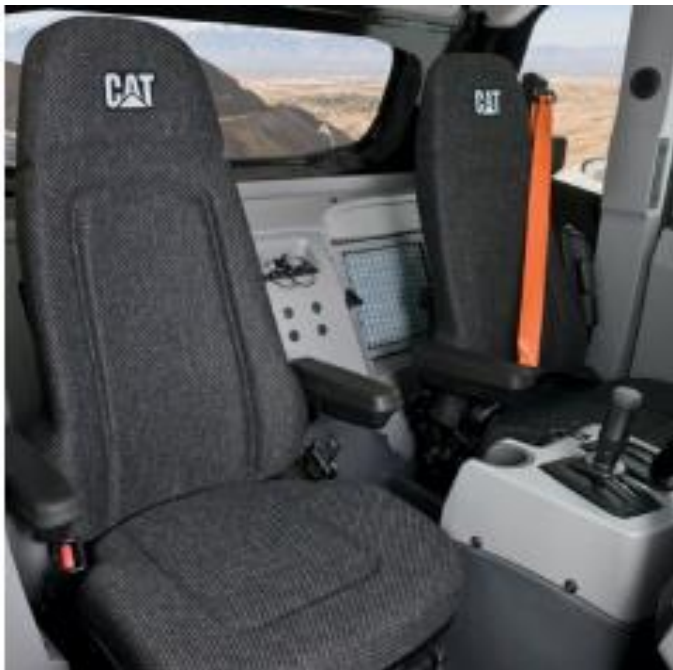
Рисунок 3.12 – Трьохточковий помаранчевий пас безпеки на сидінні оператора
