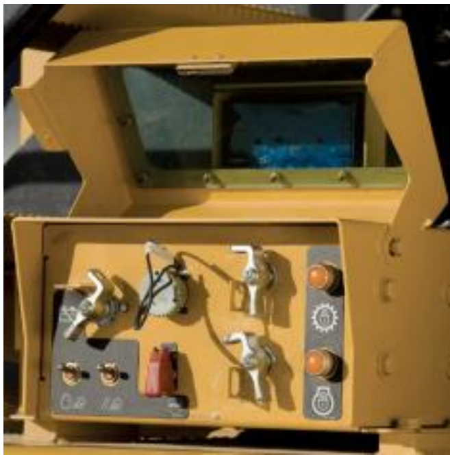
Рисунок 3.11 – Ізольований вузол блокувальних вимикачів
