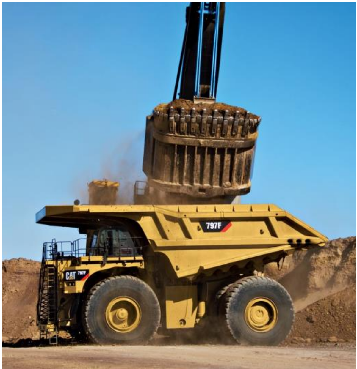
Рисунок 4.6 – Момент завантаження самоскиду Caterpillar 797F екскаватором
