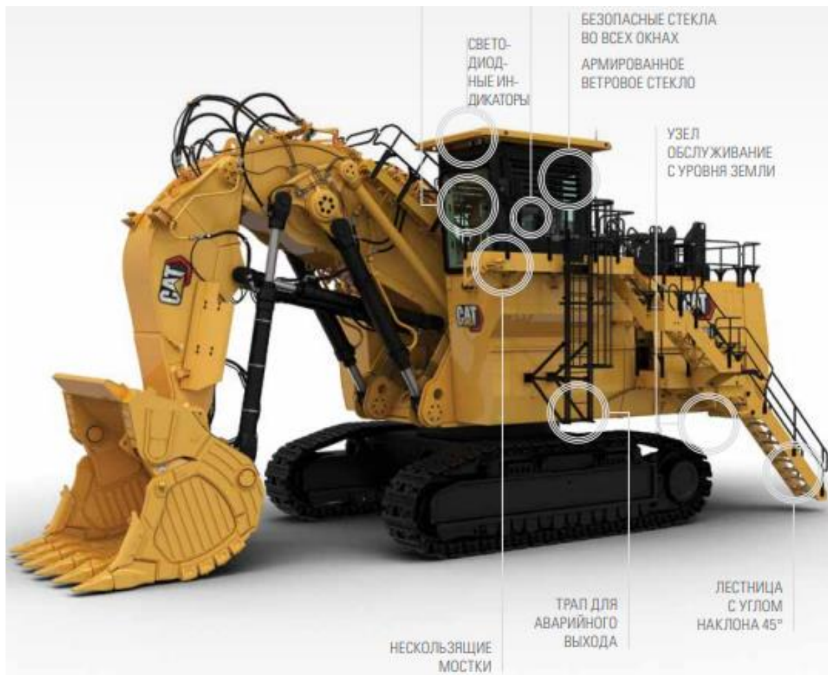
Рисунок 3.3 – Элементы підвищення безпеки для екскаватора Cat 6030
