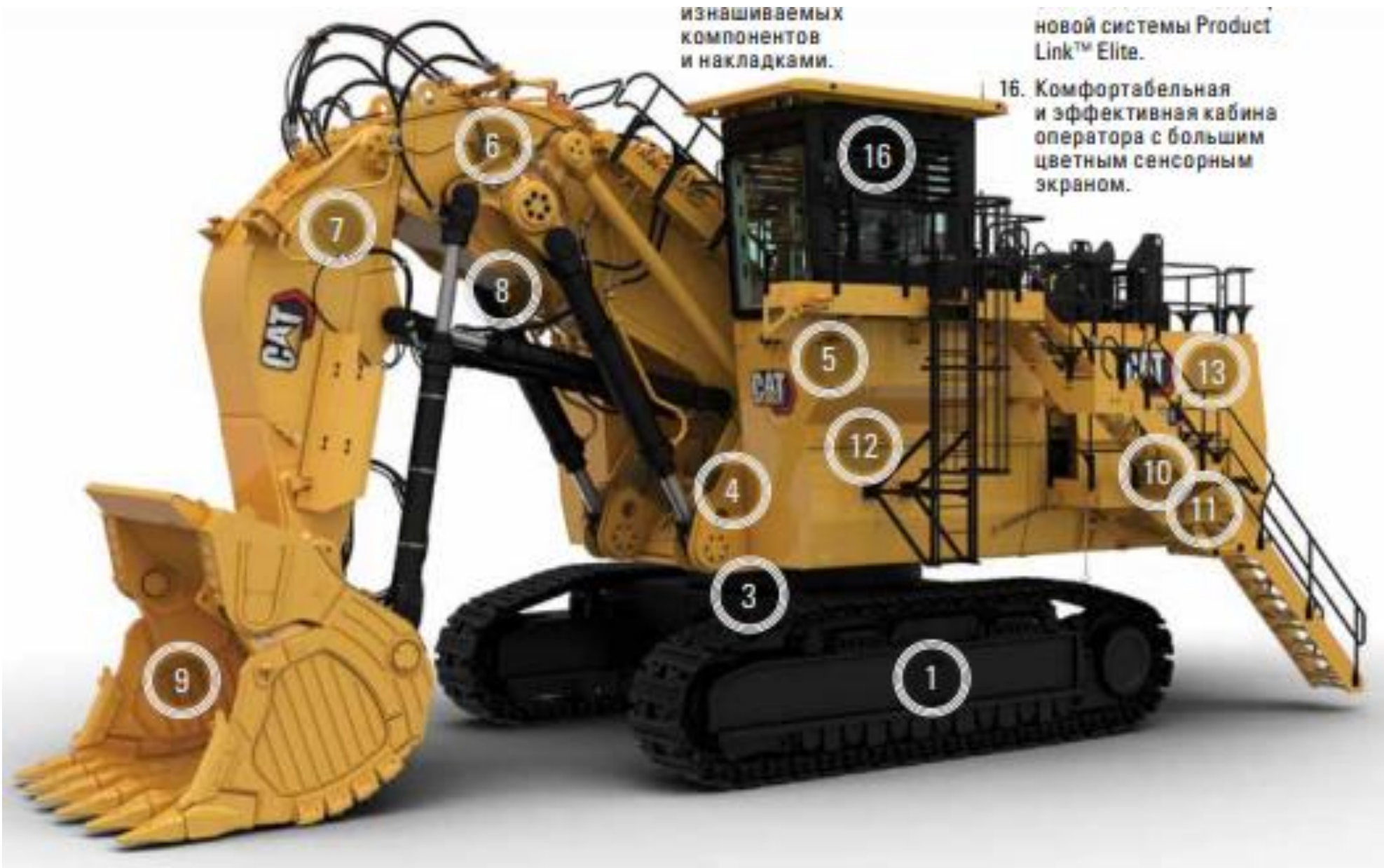
Рисунок 3.1 – Основні вузли екскаватора Cat 6030
