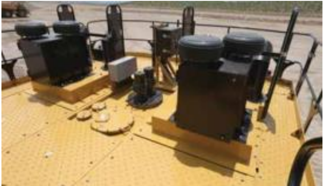
Рисунок 4.6 – Платформа з вузлами обслуговування механізмів екскаватора
