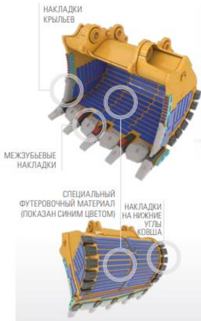
Рисунок 3.2 – Элементы підвищення зносостійкості ковша
