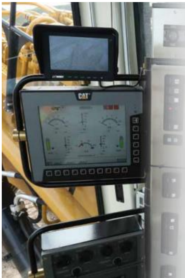
Рисунок 4.4 – 12-дюймовий сенсорний екран у кабіні оператора
