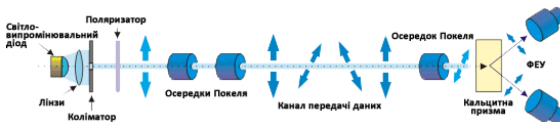
Рис.5.2 Фізична реалізація квантово-криптографічного каналу зв'язку
