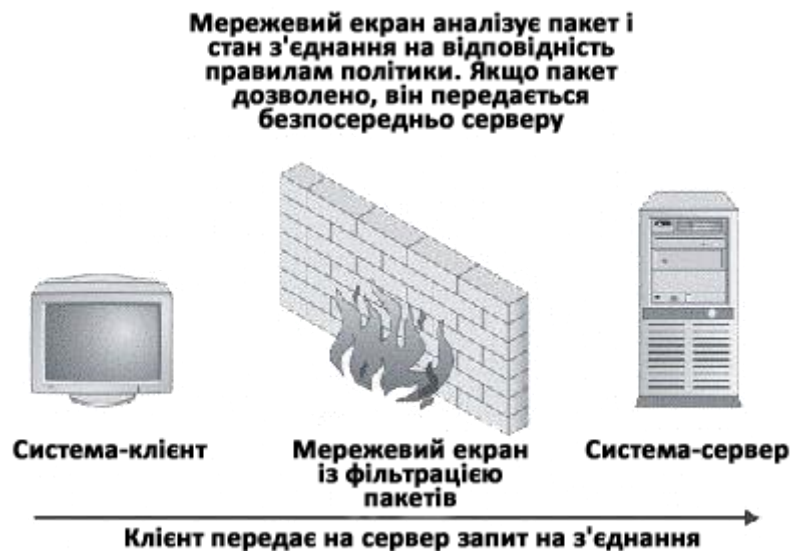
Рис. 5.5 Принцип дії фаєрволу з пакетною фільтрацією
