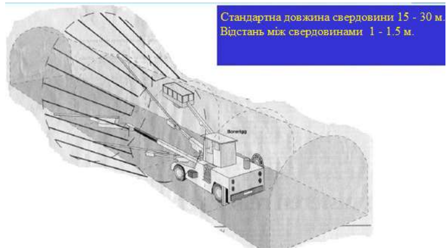
Рис 1.3. Технологія одношарового перекриття самохідними установками
