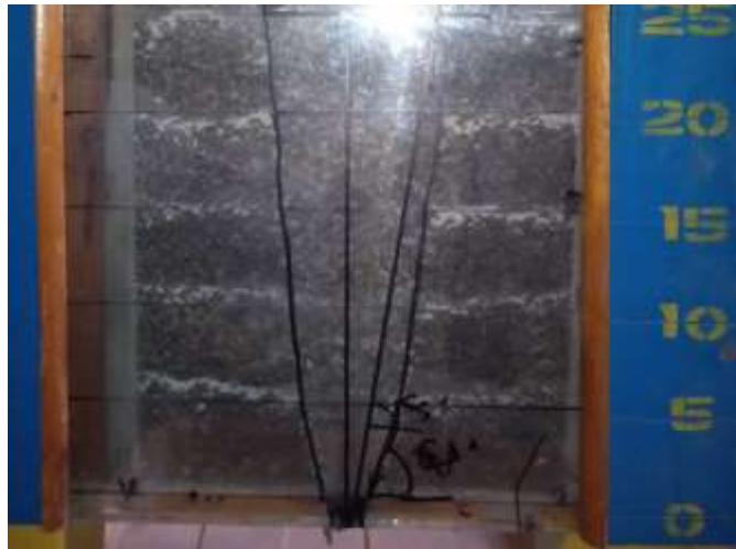
Рис. 3.7. Четверта серія досліджень. Насиченість водою 7%. Модель під час випуску
