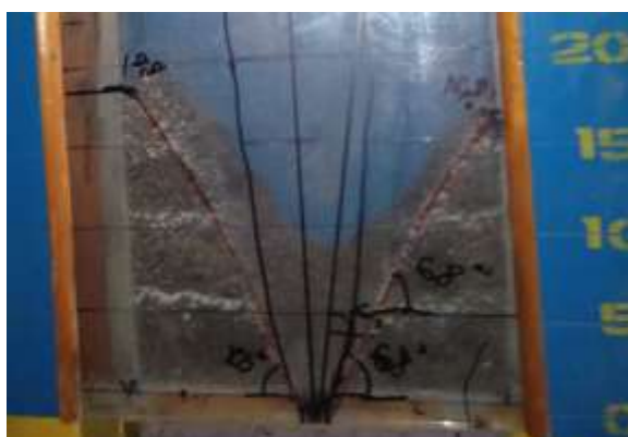
Рис. 3.5. Третя серія досліджень. Насиченість водою 6%. Модель під час випуску
