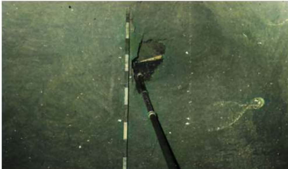
Рис. 2.8. Процес гідроруйнування мартитових руд у стінці орту 74а панелі 76-72 гор. 1195 м шпуровою гідромоніторною установкою
