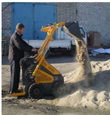
Рис. 1. Міні навантажувач з колісним рушієм
