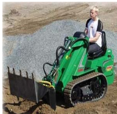
Рис. 2. Міні навантажувач з гусеничним рушієм
