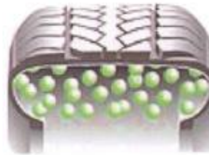
Рис. 3.3. Загальний спрощений вигляд процесу дифузії при заповненні шини азотом.
