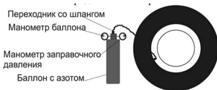
Рис. 3.8. Принципова схема системи відновлення тиску у високонавантажених шинах.
