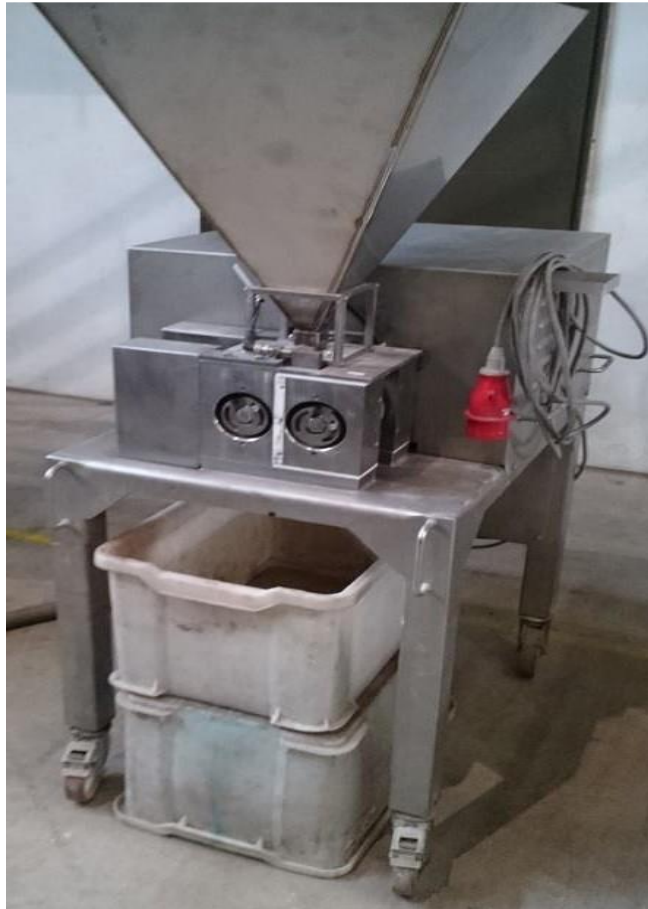
Рис. 2.6 – Експериментальний прес-валок для випробування на знос
