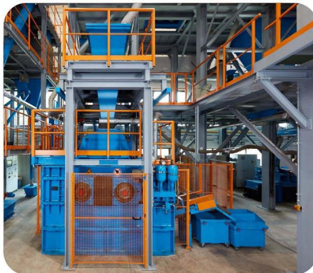
Рис. 2.8 - Напівпромисловий ролер-прес Коеррерн 60/10-230
