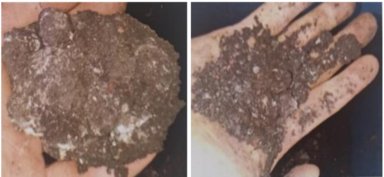
Рисунок 3.2 – Продукт подрібнення в ролер-пресі
