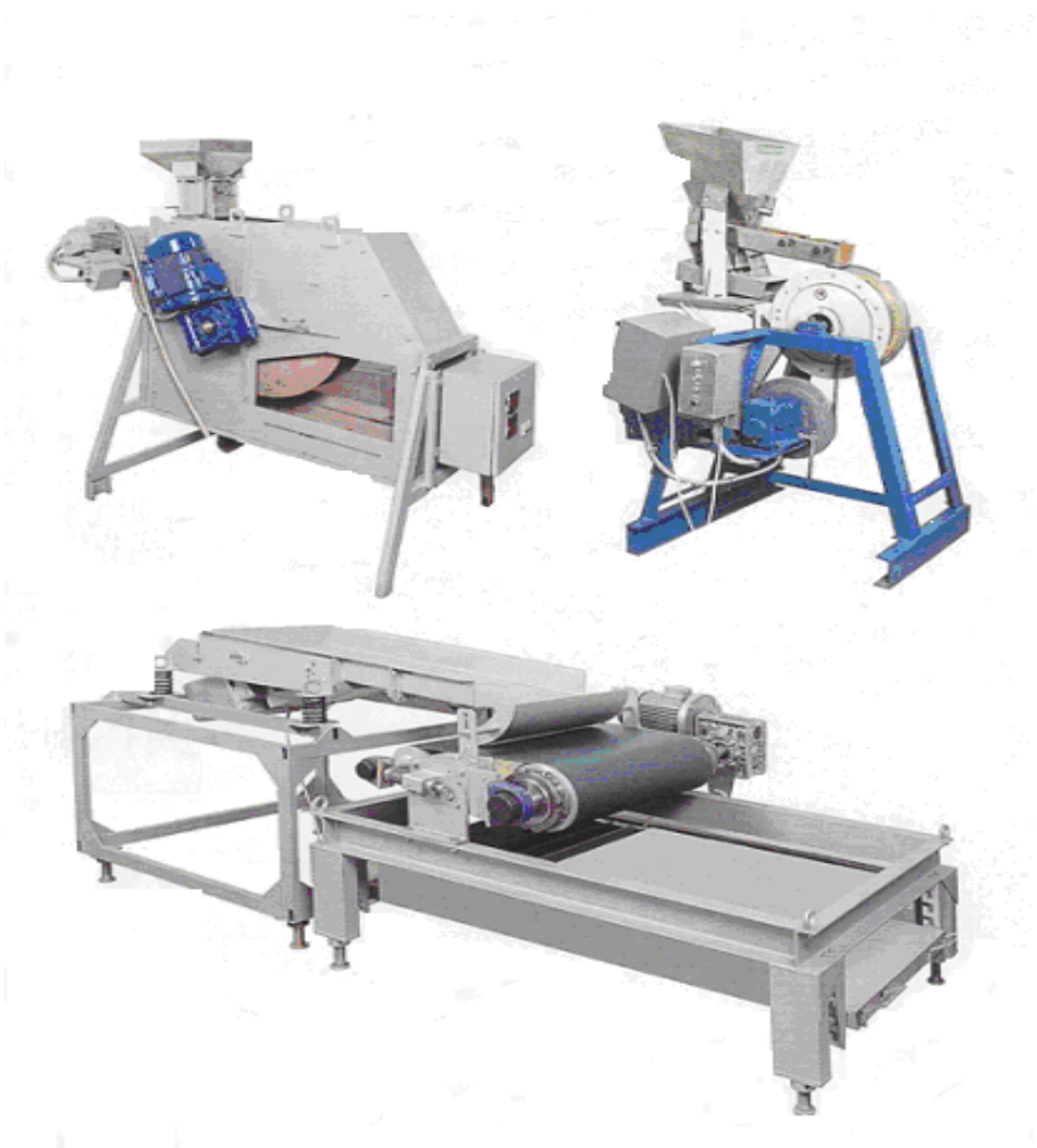
Рис. 1.9. – Сепаратори НВФ «Продекологія»: а – барабанний, б – валковий, г – роликовий.
