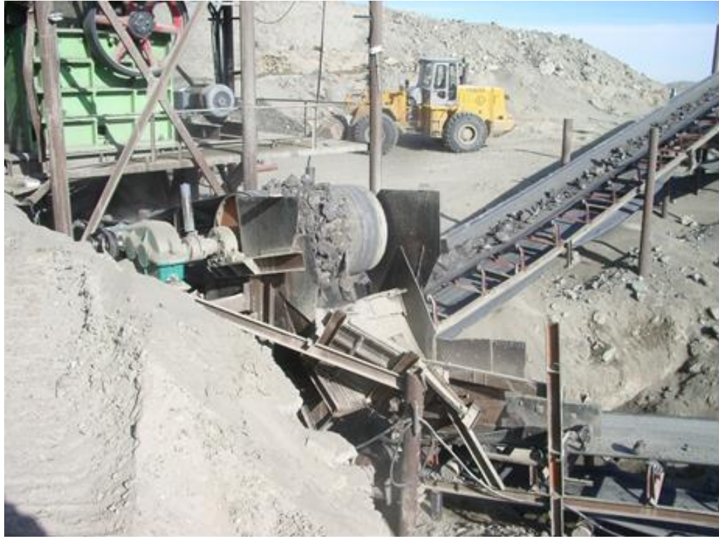
Рисунок 3.1- Вузол крупної магнітної рудорозборги у Монголії (сепаратор Китайського виробництва)
