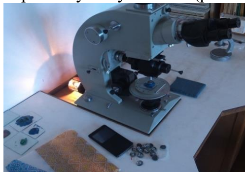
Рисунок 2.2 - Тринокулярний поляризаційний мікроскоп типу IS.1053
