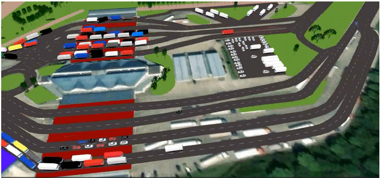
Рис. 3.3. Смуги обслуговування для вантажних АТЗ (виїзд – південна частина, та в'їзд – північна частина)
