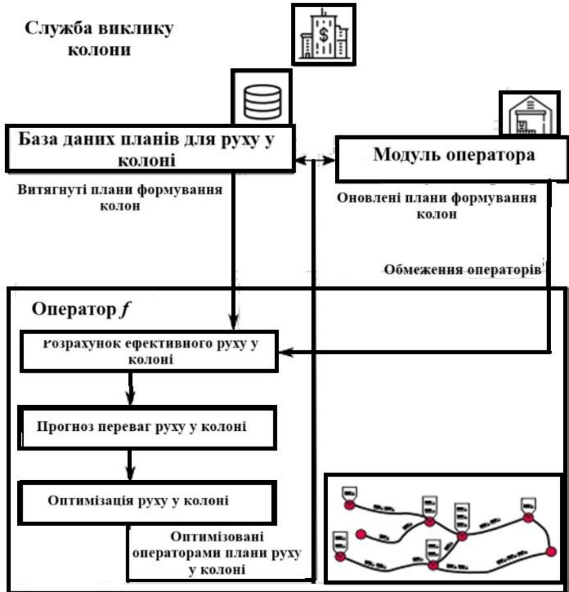
Рис.1.5. Функціональна системна архітектура опорного пункту зв'язку для руху у колоні.
