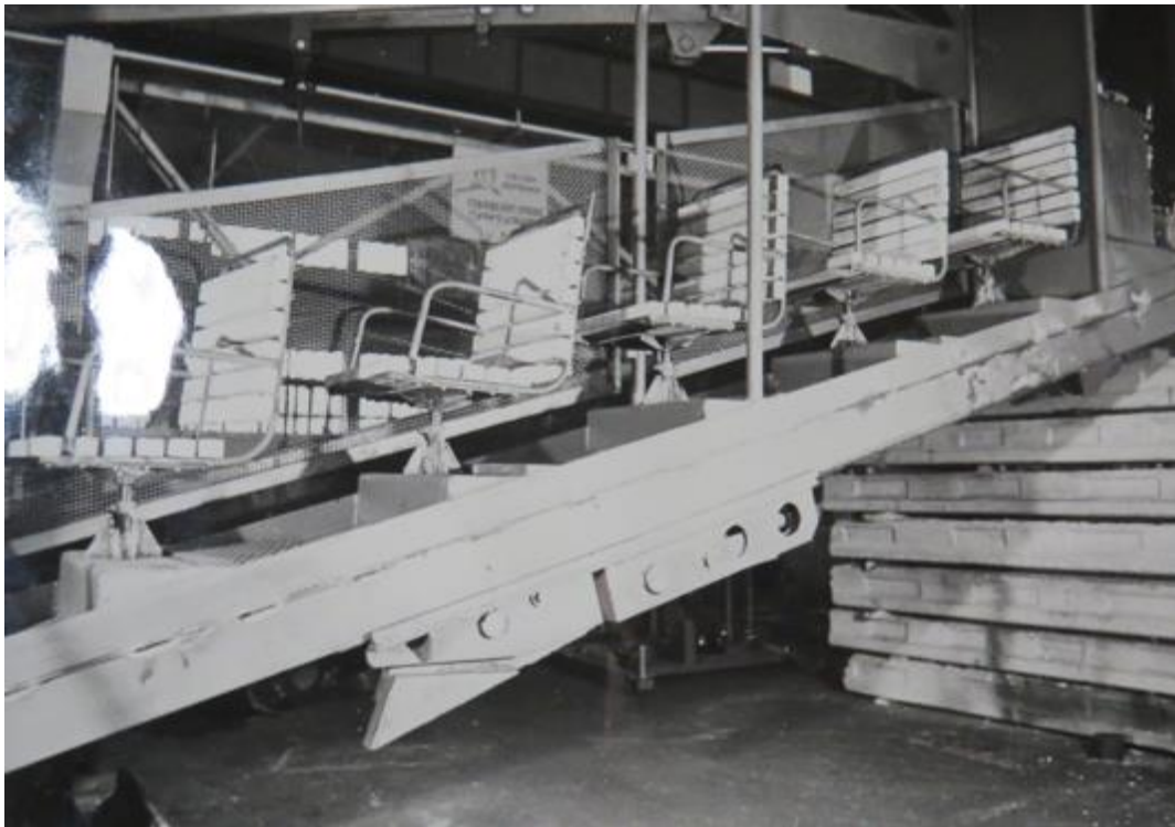
Рисунок 3.5 – Гальмова каретка вагонетки ВІРН з піднятими упорами
