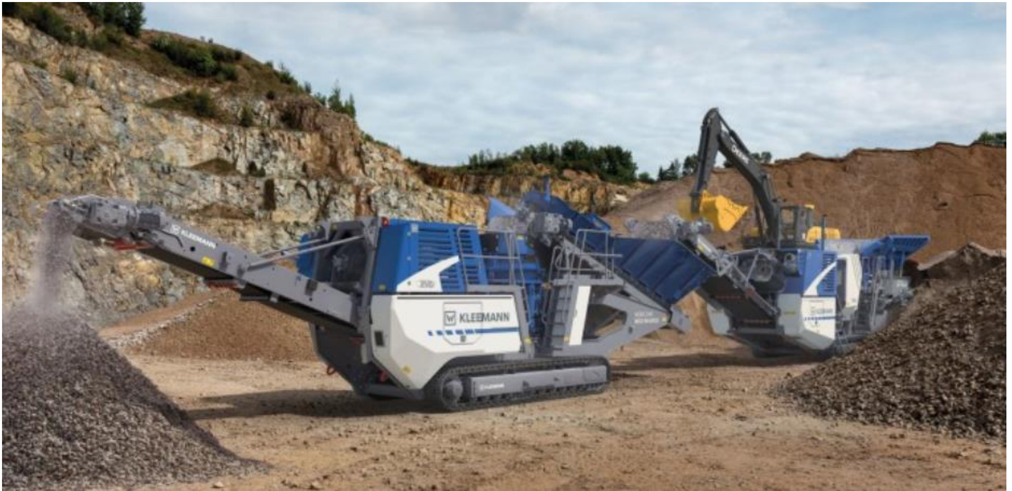
Рисунок 4.4 – Технологічний ланцюг переробки мінеральної сировини (справа-наліво): екскаватор – щокова дробарка MOBICAT MC 120(i) PRO – конусна дробарка MOBICONE MCO 110(i) PRO
