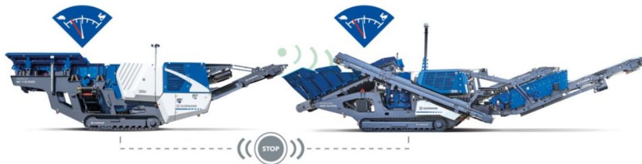
Рисунок 4.3 – Двостадійна технологічна лінія дроблення мінеральної сировини мобільними дробарками щоківового та конусного типів
