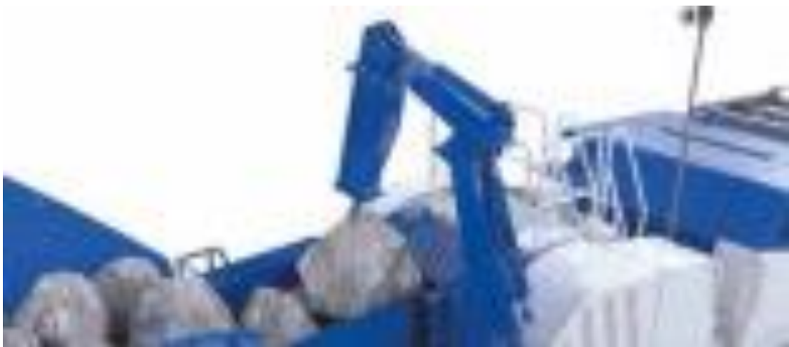
Рисунок 3.6 – Гідравлічний молот щокової дробарки
