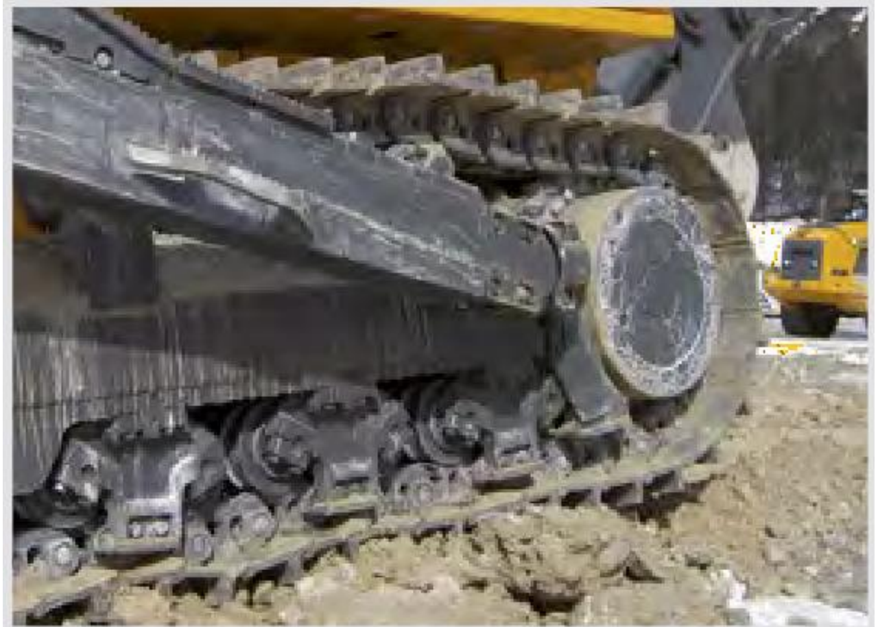
Рис 1.10 – Опорні катки бульдозеру Liebherr PR 764 [12]
