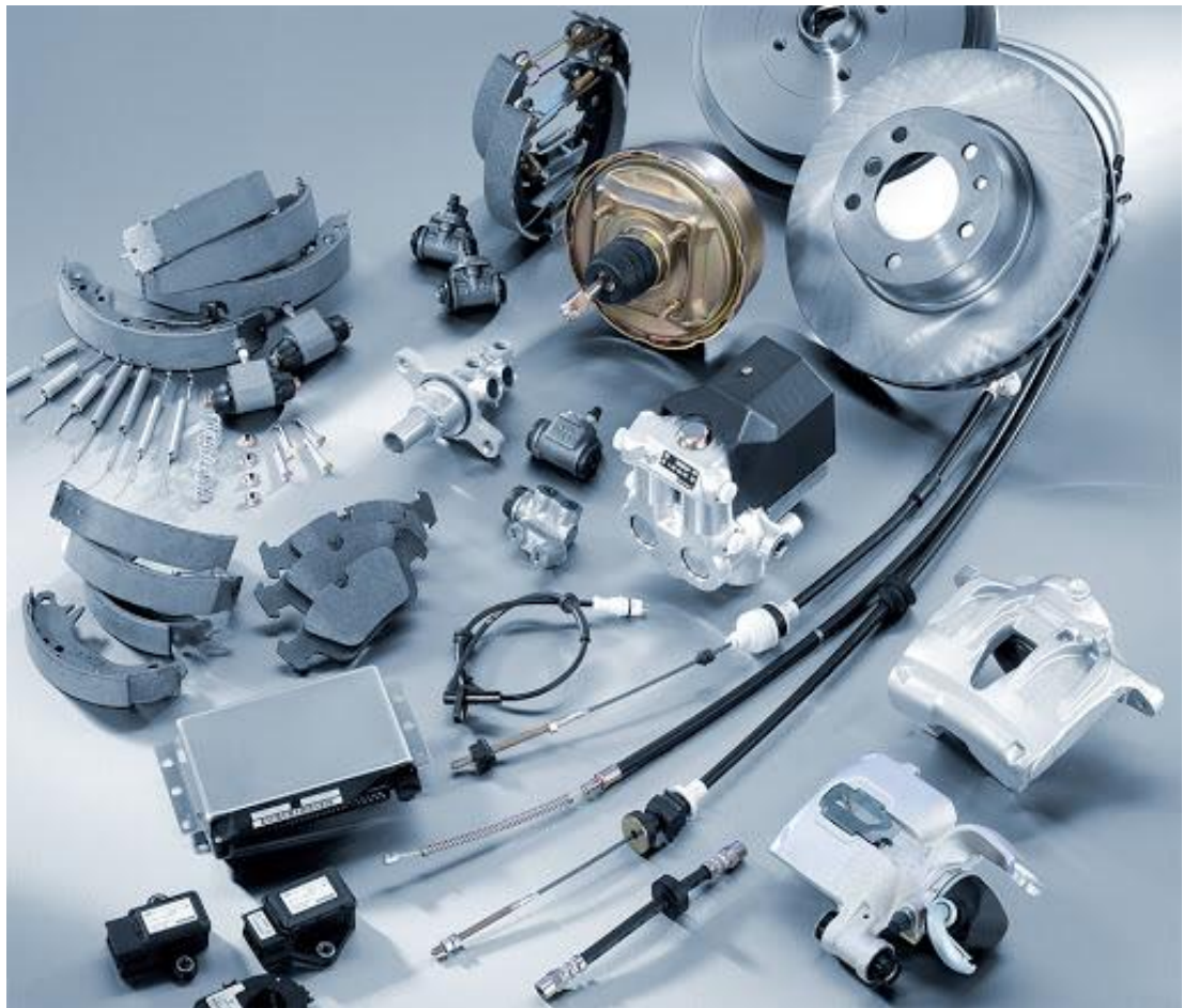
Рис. 1.1. Приклад комплекту компонентів сучасної гальмівної системи автомобіля.
