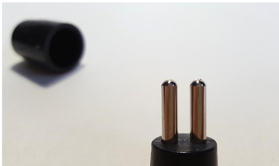
Рис. 3.10. Вигляд електродних щупів тестера гальмівної рідини.
