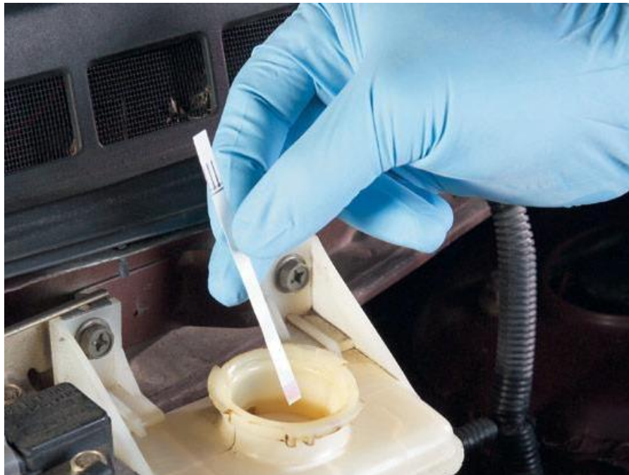
Рис. 3.7. Перевірка стану гальмівної рідини зза допомогою тест-смужки (наявність води).
