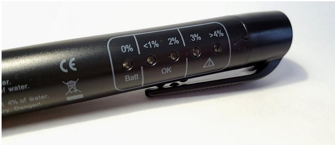
Рис. 3.12. Шкала електронного тестера у вигляді лінійки світлодіодів.
