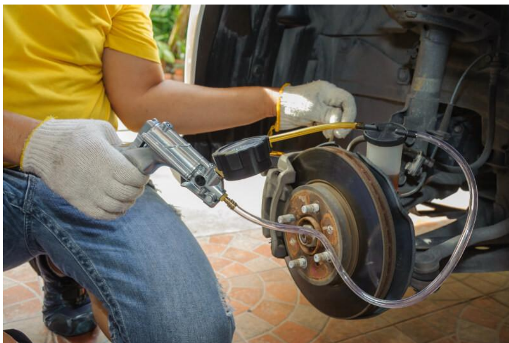
Рис. 3.14. Процес заміни гальмівної рідини методом відкачування.
