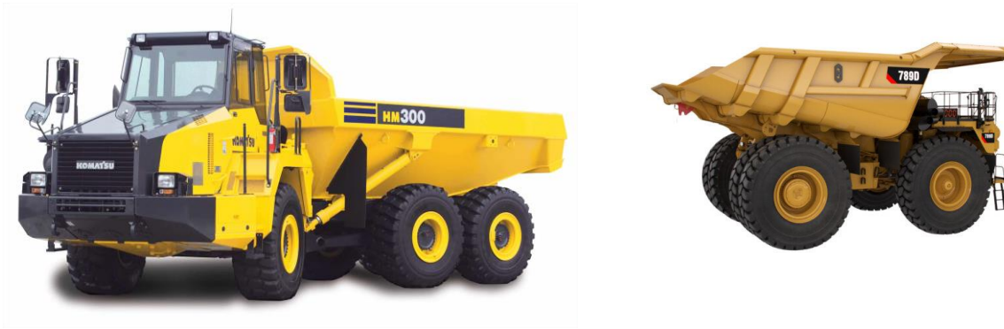
Рис.1.4. Кар'єрний автосамоскид з шарнірно-зчленованою рамою (а) та автосамоскид із жорсткою рамою (б)
