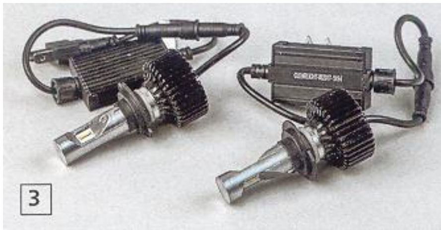
Рис. 3.8. Світлина комплекту світлодіодних джерел світла з цоколем H 7 під назвою Clearlight LED laser vision.
