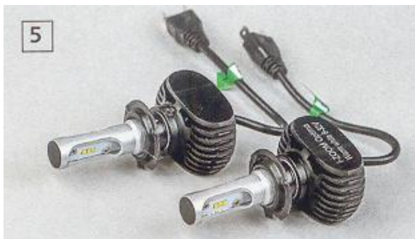
Рис. 3.10. Світлина комплекту світлодіодних джерел світла з цоколем Н 7 під назвою I-zoom H7 Optima.
