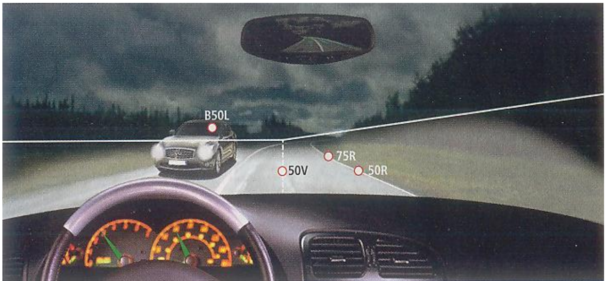
Рис. 2.5. Візуалізація розташування контрольних точок для визначення освітленості європейської системи світлорозподілу на ближньому світлі.
