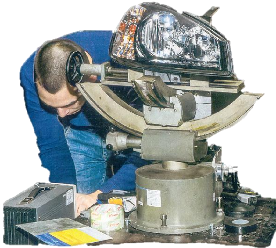
Рис. 4.18. Візуалізація процесу встановлення та налаштування позиції освітлювального приладу для проведення комплексу тестувань світлодіодних ламп з цоколем Н 7
