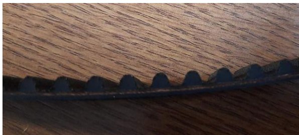
Рис. 4.4. Загальний вигляд піддослідного зразка 3, з профілем зубців (комплект «Dayco»).
