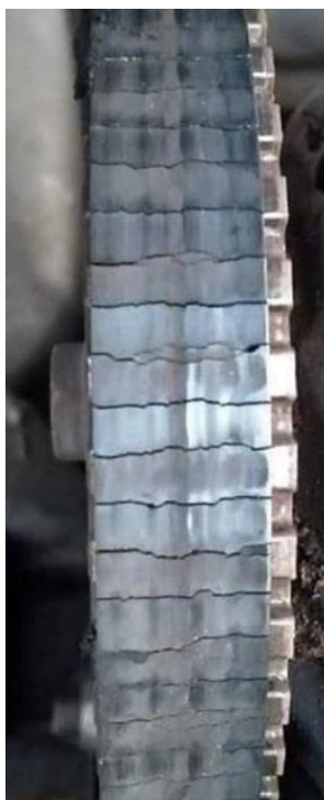
Рис. 4.8. Світлина з наявними пошкодженнями зразка №5 «Federal mogul» по завершенні повного строку ресурсних випробувань на стенді.
