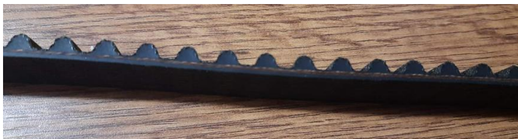
Рис. 5.6. Профіль зубців резино-армованого ремня з комплекту виробника «Continental»
