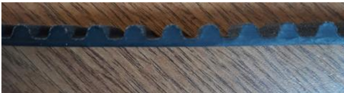
Рис. 4.2. Профіль зубців резино-армованого ремня з комплекту виробника «Bosch»
