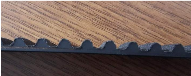
Рис. 4.3. Загальний вигляд піддослідного зразка 2, з профілем зубців (комплект «Gates»).
