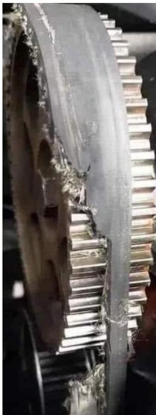
Рис. 4.9. Світлина з наявними ушкодженнями зразка 6 під назвою «Gates» по завершенні повного строку ресурсних випробувань на стенді.
