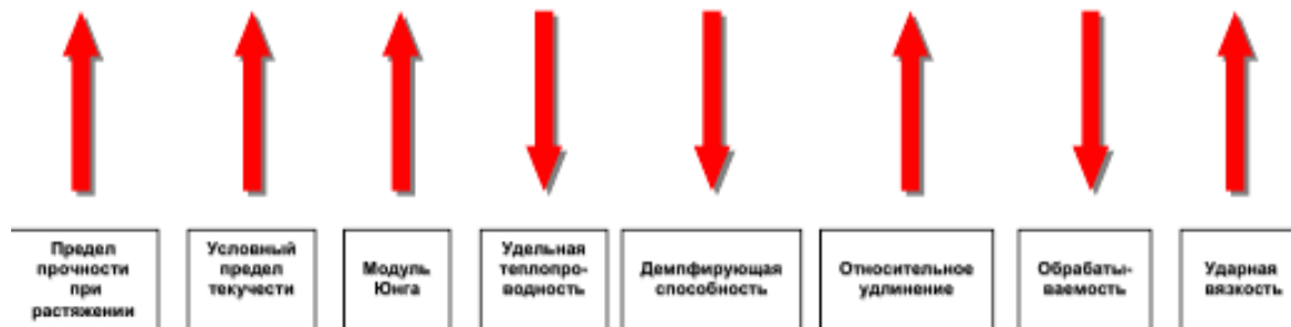
Рисунок 3.6. Вплив збільшення ступені шаровидності графіту на деякі властивості ЧВГ.
