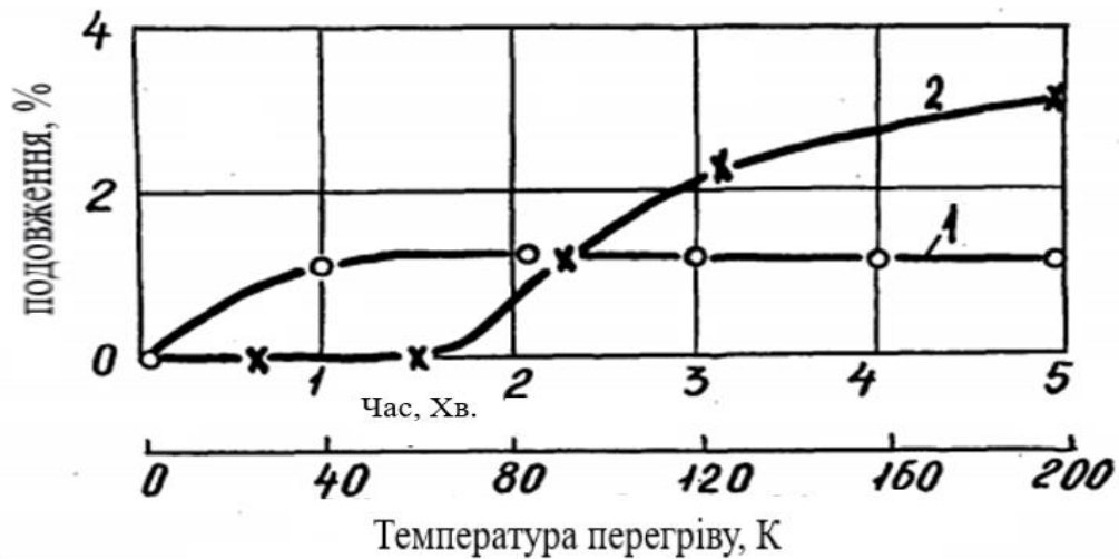
Рис. 3.19. Вплив тривалості віброобробки та температури перегріву на пластичність силуміну АК12пч О - О - вплив часу віброобробки; Х - Х - вплив температури перегріву над ліквідусом.
