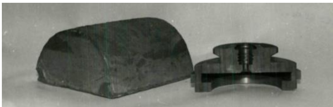
Рис.3.24. Виливок і деталь горлове кільце
