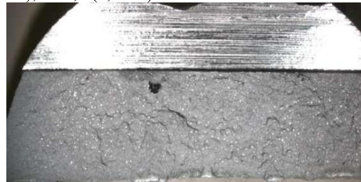
Рисунок 3.14 - Злами технологічних проб до і після рафінування розплаву АК12: a, в - до дегазації; б, г - після дегазації. K_d , % (номер проби, номер плавки в печі): a - 3,48 (5, № 5); б - 0,77 (6; № 5); в - 3,08 (7; № 1); г - 0,6 (8; № 1)
