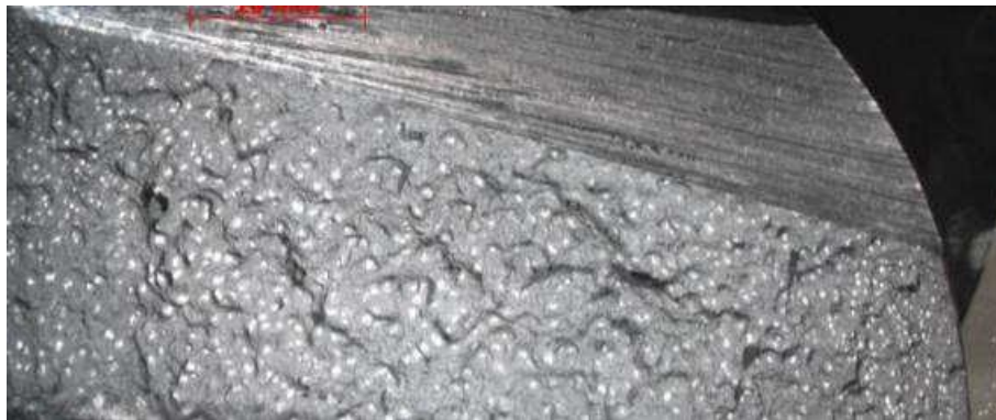
Рисунок 3.13 - Злами технологічних проб до і після рафінування розплаву АК12: a, в - до дегазації; б, г - після дегазації. K_d , % (номер проби): a - 3,32 (1); б - 1,94 (2); в - 3,55 (3); г - 1,36 (6)
