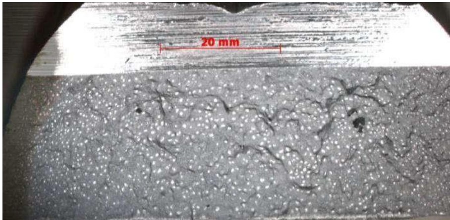
Рисунок 3.16 - Злами технологічних проб до і після рафінування розплаву АК12 (номер плавки в печі № 1): а - до дегазації; б - після дегазації. K_d , % (номер проби): а - 6,3 (14); б - 1,08 (15)
