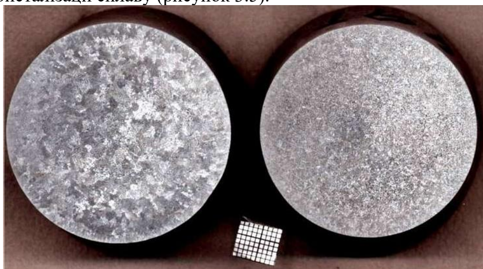
a б Рисунок 3.5 - Макроструктура проб металу з різними значеннями індексу щільності - вмістом водню та оксидними плінами, %: a - 9,1; б - 14
