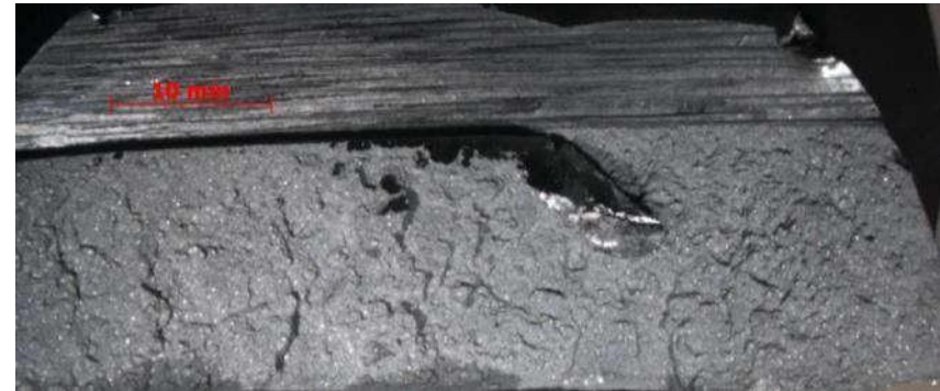
Рисунок 3.14 - Злами технологічних проб до і після рафінування розплаву АК12: a, в - до дегазації; б, г - після дегазації. K_d , % (номер проби, номер плавки в печі): a - 3,48 (5, № 5); б - 0,77 (6; № 5); в - 3,08 (7; № 1); г - 0,6 (8; № 1)
