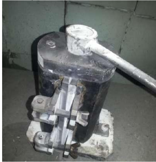
Рисунок 2.3 - Кокіль для виготовлення технологічних проб
