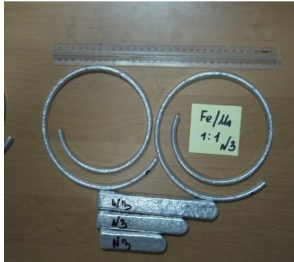
Рисунок 3.28 - Залежність рідинотекучості від співвідношення Fe : Mn: а - 1 : 0, б - 1 : 0,5, в - 1 : 1; г - значення рідини плинності
