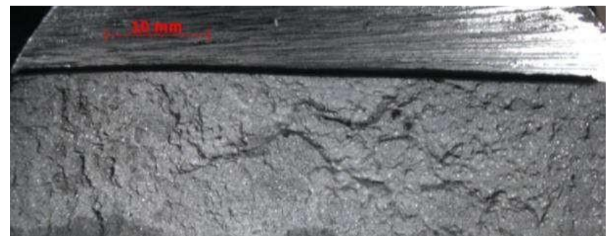
Рисунок 3.13 - Злами технологічних проб до і після рафінування розплаву АК12: a, в - до дегазації; б, г - після дегазації. K_d , % (номер проби): a - 3,32 (1); б - 1,94 (2); в - 3,55 (3); г - 1,36 (6)
