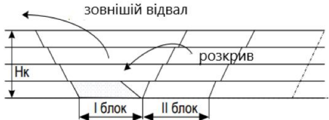
Рис. 4. – Блокова система розробки за Б.Т. Рутковським: H_k - глибина кар'єру, м.
