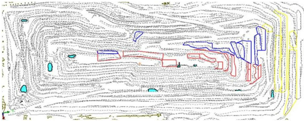
Рис. 1.8. Контури для відпрацювання місячного плану гірничих робіт в кар'єрі
