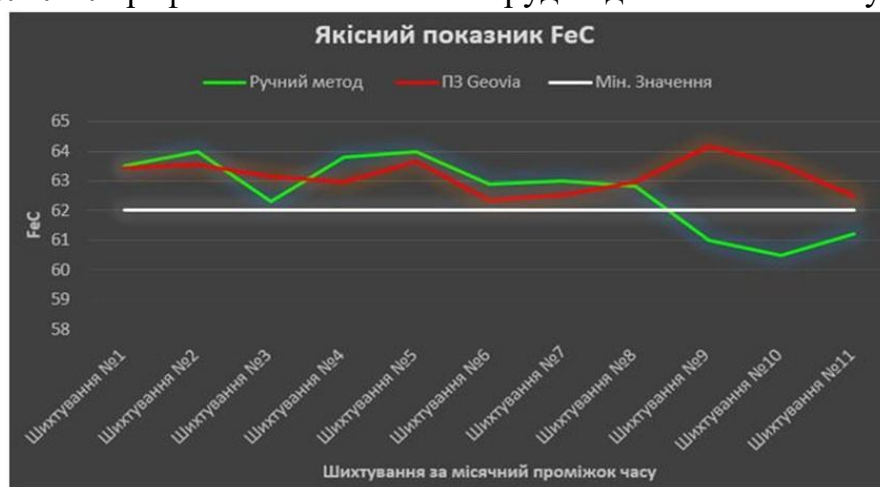
Рис. 1.13. Графік залежності FeC з руди від кількості шихтувань Планувальник Micromine Beyond Scheduler
