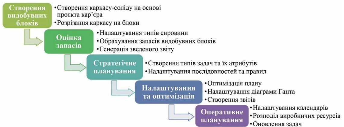
Рис. 1.15. Алгоритм процесу планування відкритих гірничих робіт за допомогою Micromine Scheduler
