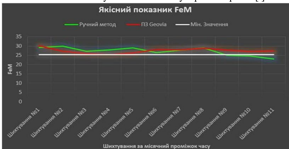
Рис. 1.12. Графік залежності FeM в руді від кількості шихтувань
