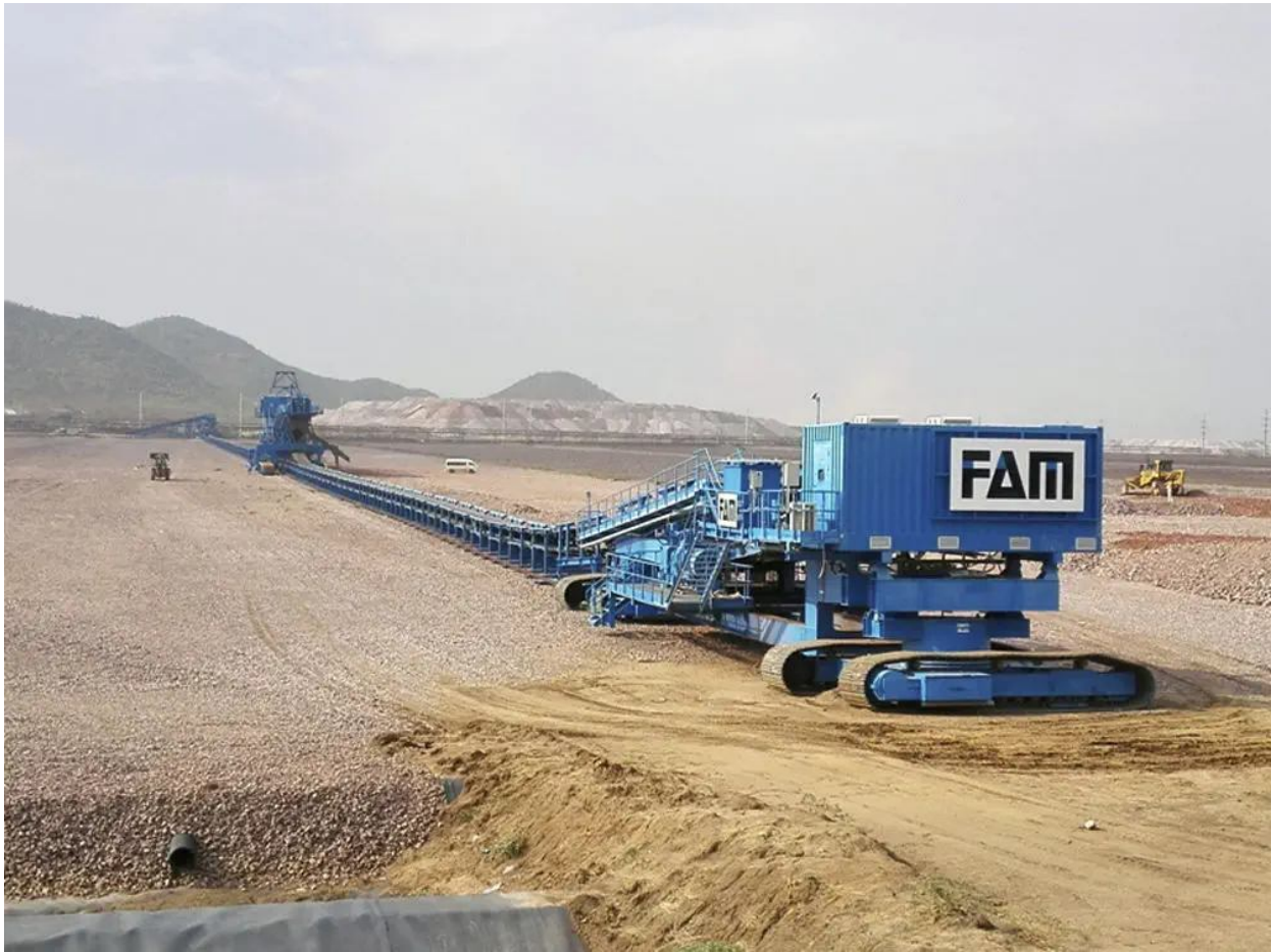
Рис. 2.1 – Мобільний конвеєрний комплекс на гусеничному ході (Німеччина)
