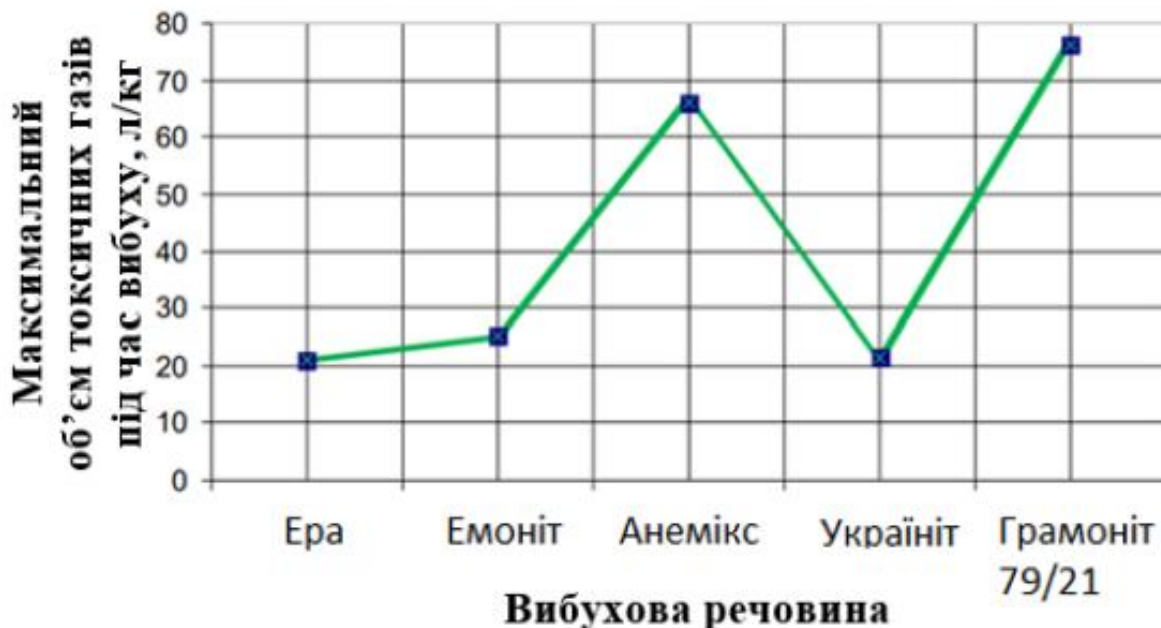
Рисунок 21 – Максимальний обсяг токсичних газів під час підривання вибухових речовин за нормальних умов
