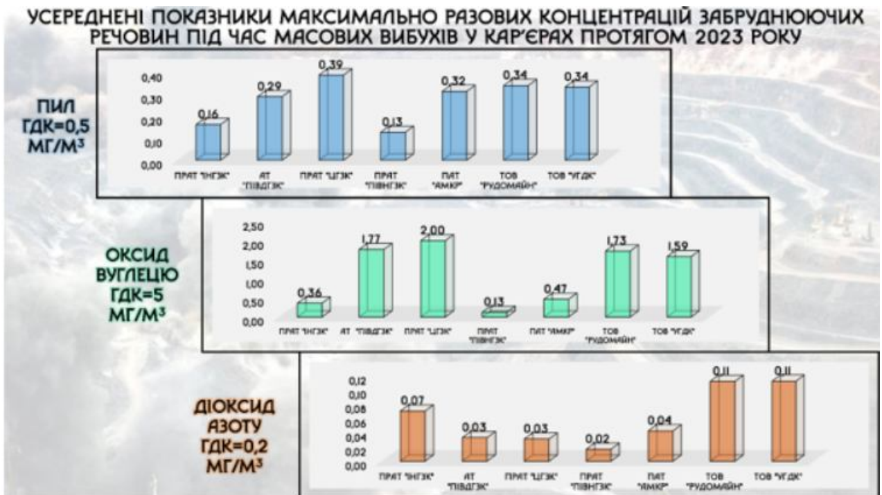
Рисунок 7 – Усереднені показники викидів пилу, оксиду вуглецю та діоксиду азоту підприємствами кривого Рогу під час масових вибухів.
