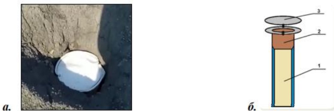
Рисунок 32 – Рукав зарядний універсальний: а - РЗУ в свердловині; б - схема (1 - зарядна частина, 2 – забійкова частина, 3 – клапан, що закривається)
