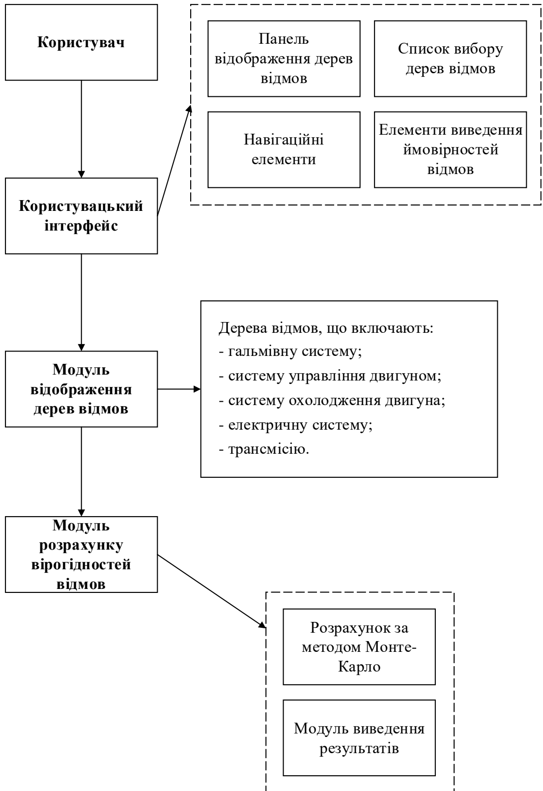
Рисунок 2.1 - Функціональна схема комплексу автоматизації оцінки надійності критичних систем автомобіля на основі інтелектуального аналізу дерева відмов
