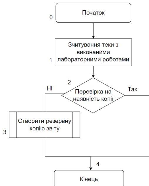
Рисунок 2.8 – Блок-схема резервного копіювання даних
