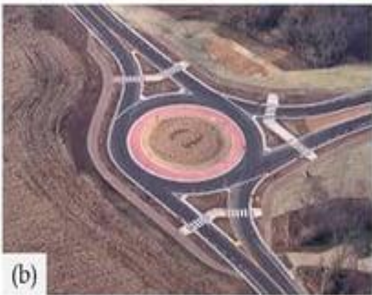
Рисунок 3. Основні типи кільцевих розв'язок: (а) міні-кільцева розв'язка, (б) односмугова кільцева розв'язка та (с) багатосмугова кільцева розв'язка (з двома смугами руху).
