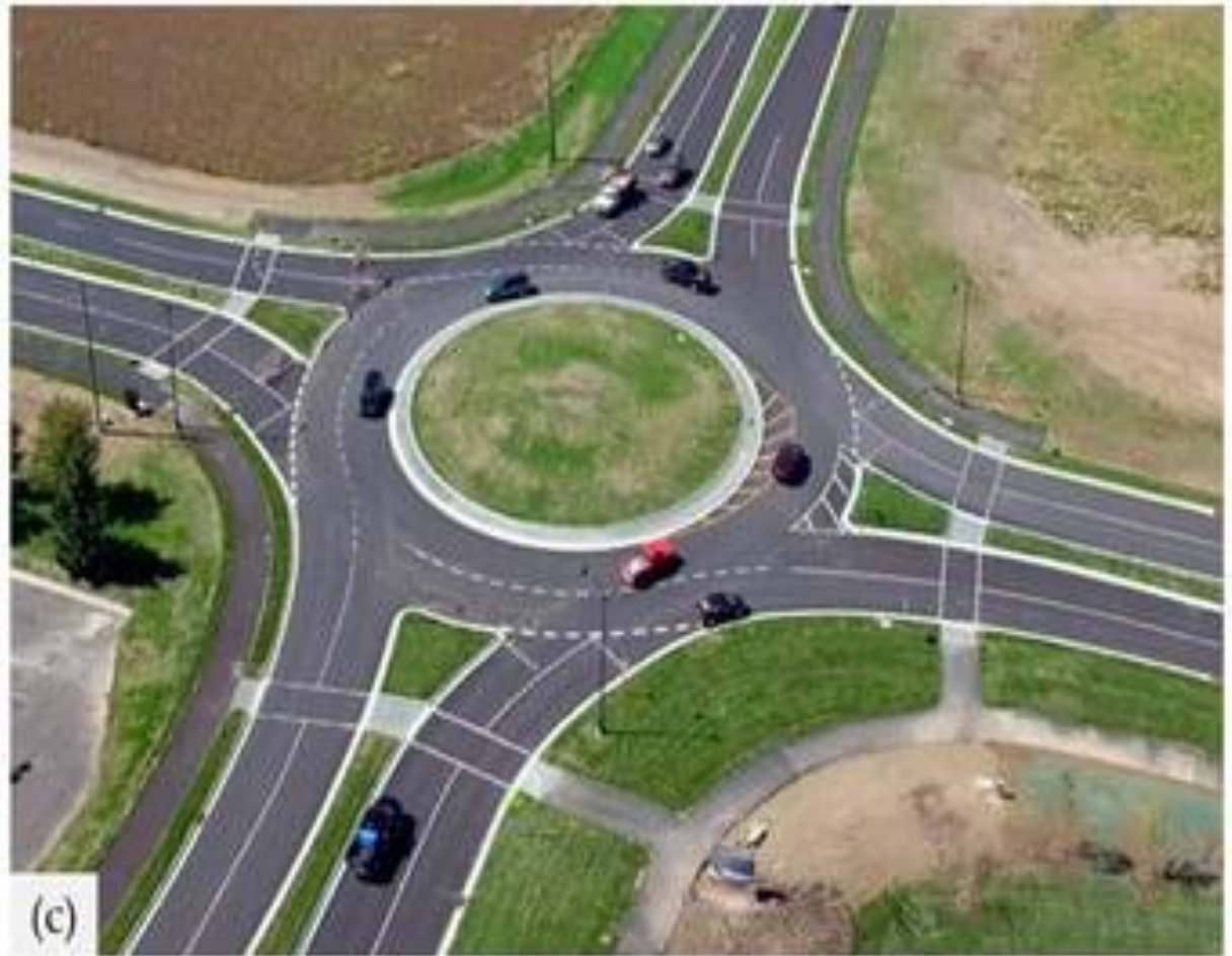
Рисунок 3. Основні типи кільцевих розв'язок: (а) міні-кільцева розв'язка, (б) односмугова кільцева розв'язка та (с) багатосмугова кільцева розв'язка (з двома смугами руху).
