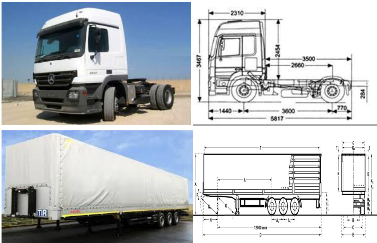
Рис.3.1. Технічна характеристика Mercedes-benz 1844-LS ACTROS 3600 та Koegel Cargo-maxx SN 24 P 90/1 .110:
