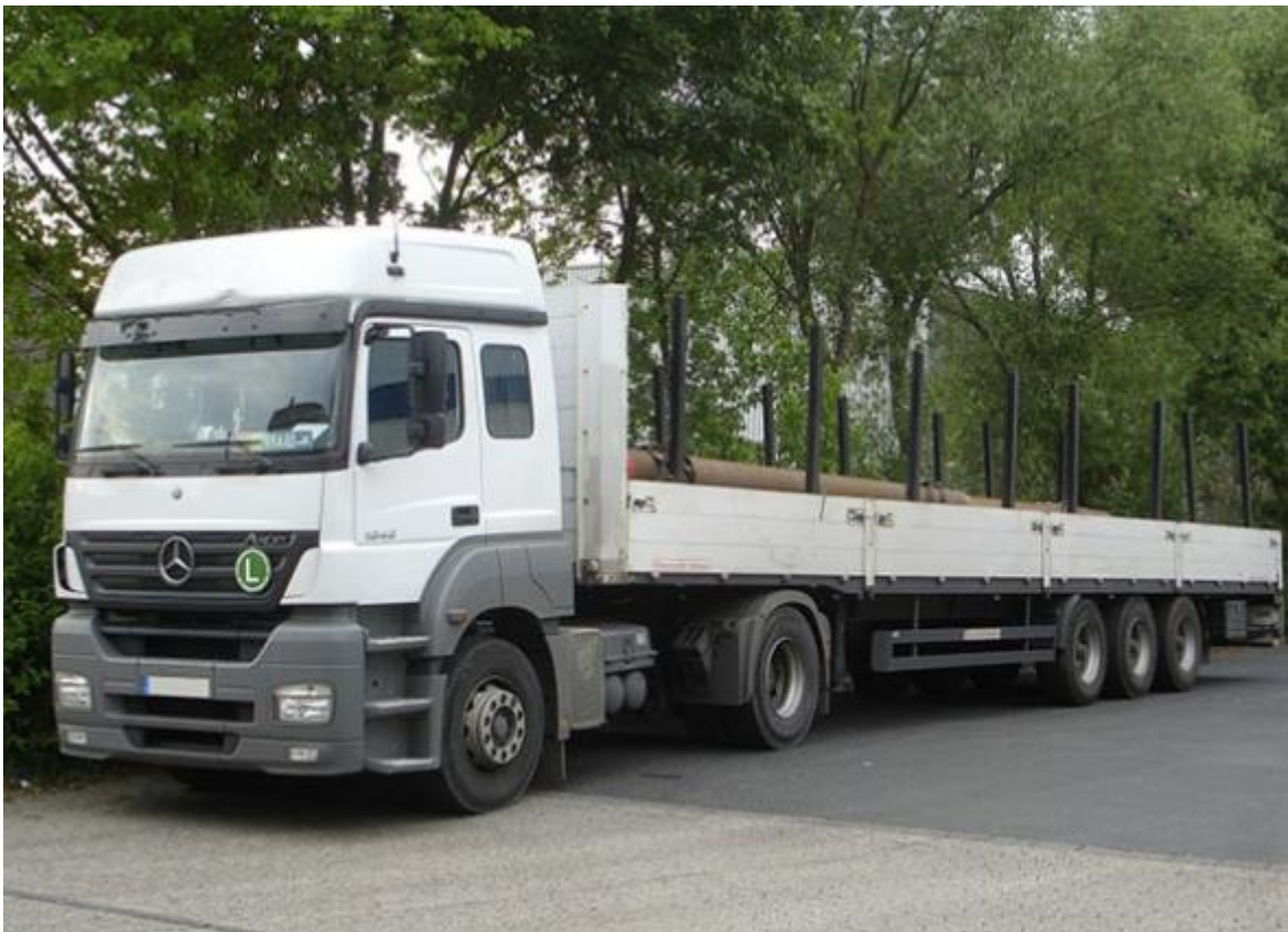
Рис.1.4. Довгомір у складі автомобіля тягача й напівпричепа
