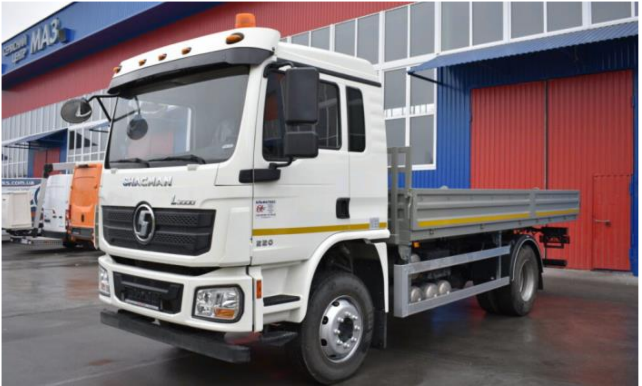
Рис.1.3. Бортовий автомобіль SHACMAN L3000 (SX5188GSS8J451)
