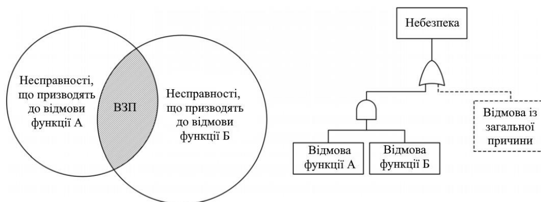
Рис. 2.6. Подання функціональної незалежності за допомогою аналізу дерева несправностей
