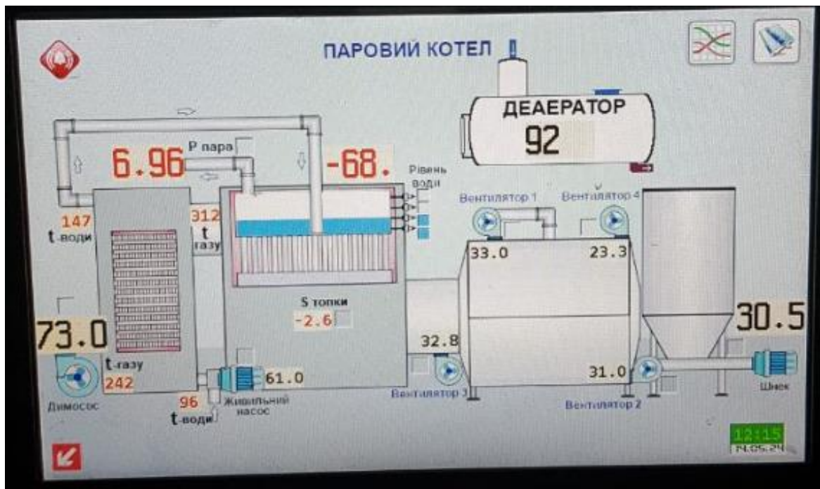
Рисунок 1.3 – Технологія переробки насіння соняшника (паровий котел)
