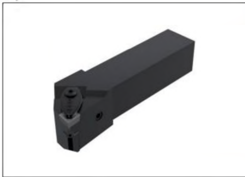
Рисунок 3.1 – Державка DCLCL2525X09JET1 [3 с. 206] Геометричні параметри: H=25мм; B=25мм; LF = 36 мм; LH = 38 мм; WF = 32 мм
