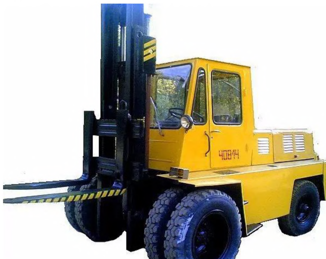
Рисунок 1.2 – Львівський автонавантажувач АП-40814
