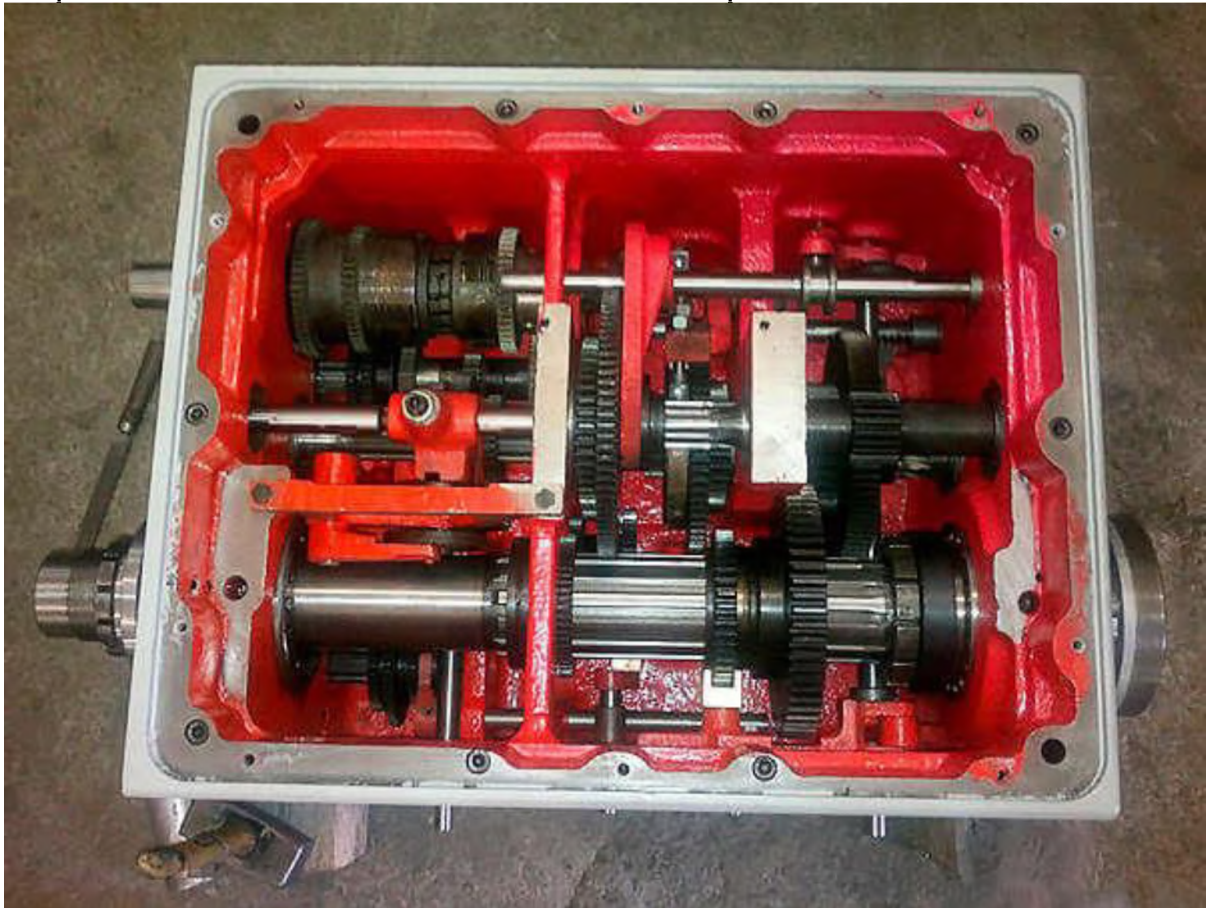
Рисунок 1.3 – Коробка швидкостей токарного верстата 1М611П
