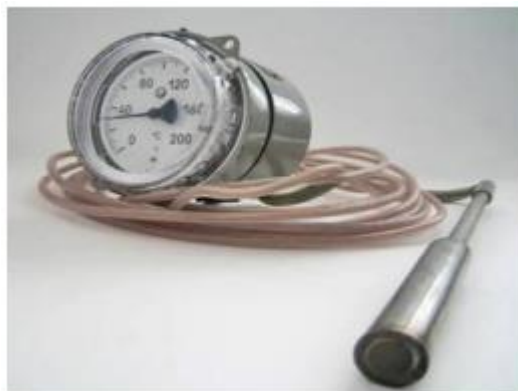
Рисунок 2.12 - Датчик температури ТГП 100ЕК
