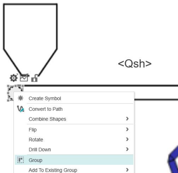
Рисунок 2.16 – Групування графічних примітивів для анімації стану конвеєра подачі шихти у гранулятор
