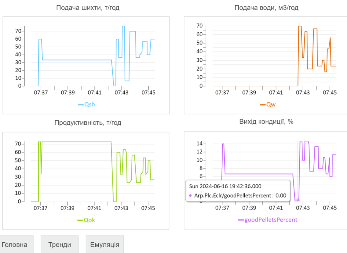
Рисунок 2.23 – Вигляд екрану трендів основних технологічних параметрів процесу виготовлення сирих котунів
