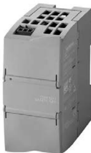
Рисунок 2.33 – Комунікаційний модуль CSM 1277
