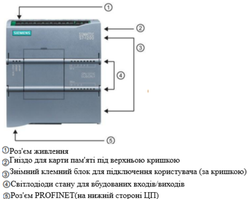
Рисунок 2.31 – Вид контролера S7-1200
