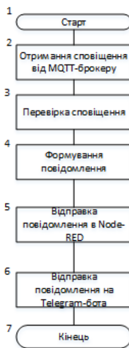
Рисунок 2.31 - Блок-схема роботи потоку "Сигналізація"
