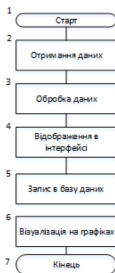
Рисунок 2.23 - Блок-схема роботи потоку "Моніторинг температури та вологості"
