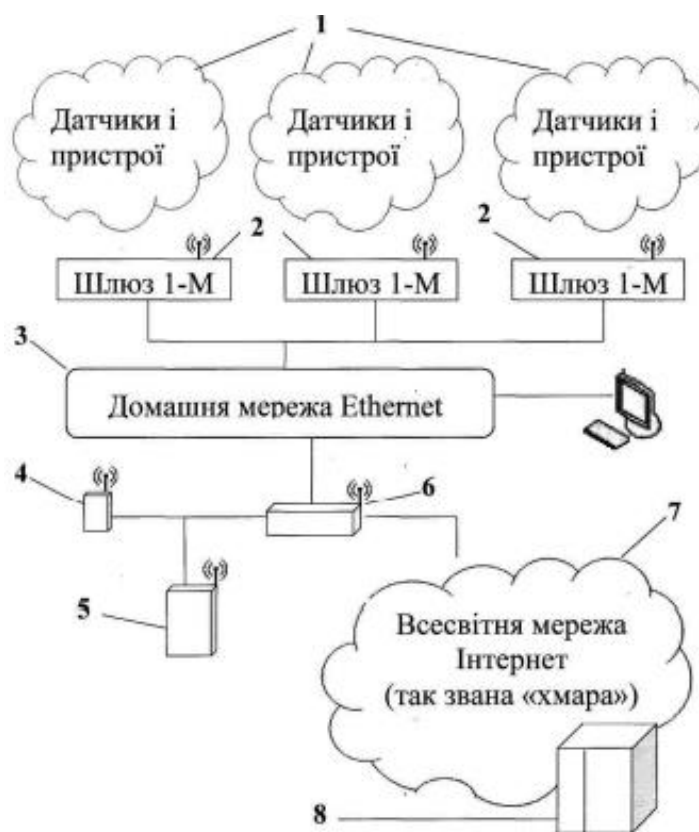
Рисунок 1.1 - Схематично зображена система управління інфраструктурою будинку "Розумний дім"
