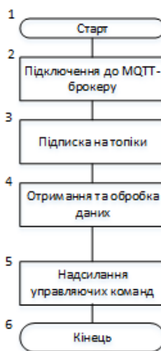
Рисунок 2.22 - Блок-схема взаємодії Node-RED та MQTT-брокера
