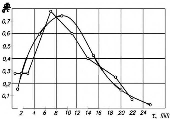
Рисунок 3.3 - Залежність швидкості зношування інструмента протягом часу роботи
