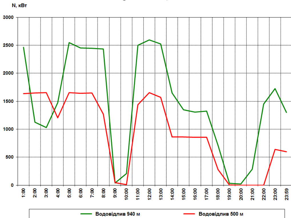
Рисунок 2.3 – Графіки споживання активної електроенергії електроприводами шахтних водовідливних установок шахти Козацька (м. Кривий Ріг)
