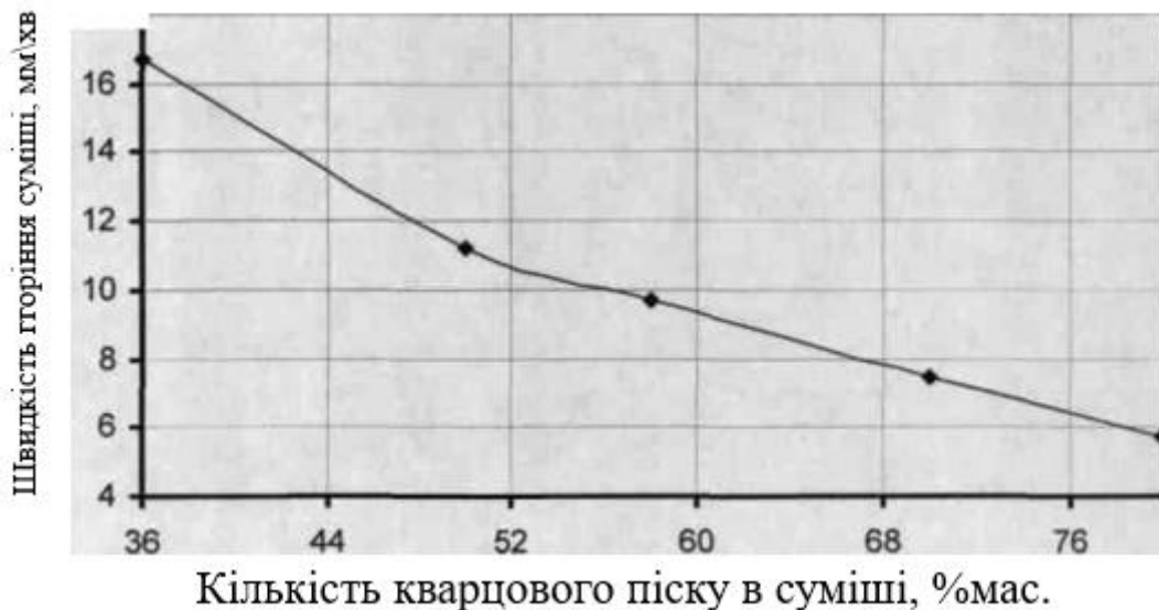
Рисунок 3.33 - Вплив кількості кварцового піску на швидкість горіння ХТЕС на лужній фенолоформальдегідній смолі
