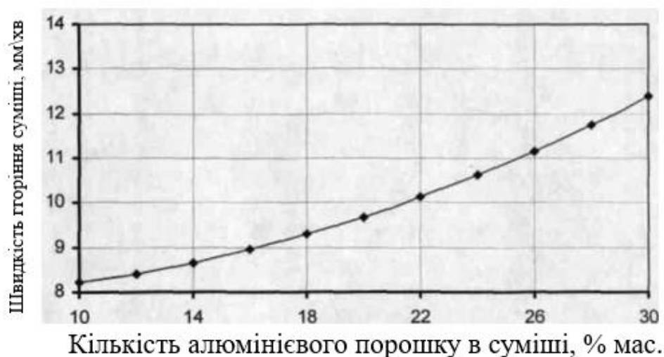
Рисунок 3.24 - Вплив кількості алюмінієвого порошку на швидкість горіння ХТЕС на лужній фенолоформальдегідній смолі
