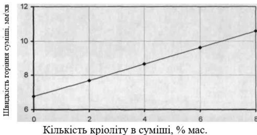
Рисунок 3.14 – Вплив кількості кріоліту на швидкість горіння горіння ХТЕС на рідкому склі
