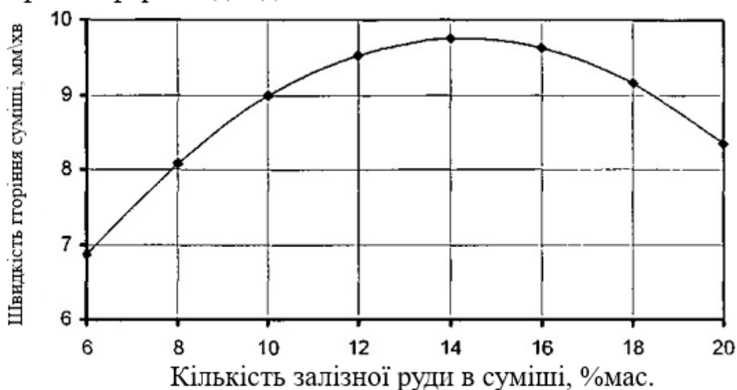
Рисунок 3.26 - Вплив кількості залізної руди на швидкість горіння ХТЕС на лужній фенолоформальдегідній смолі
