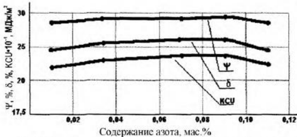
Рис. 5. Влияние азота на механические характеристики модифицированной титаном стали 110Г13Л
